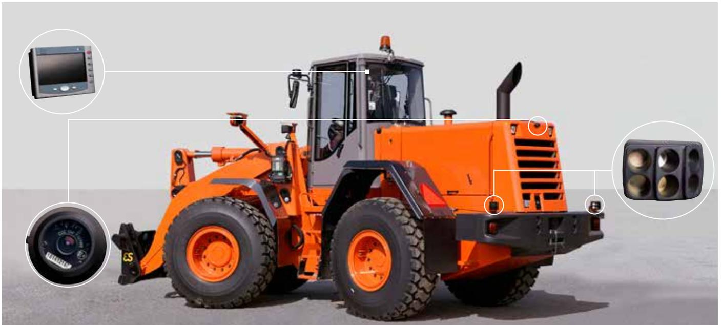
Die Kombination aus Sensoren und Kamera(s) liefert dem Fahrer passive und aktive Sicherheitsinformationen über den freien Raum in der Umgebung der Maschine.
